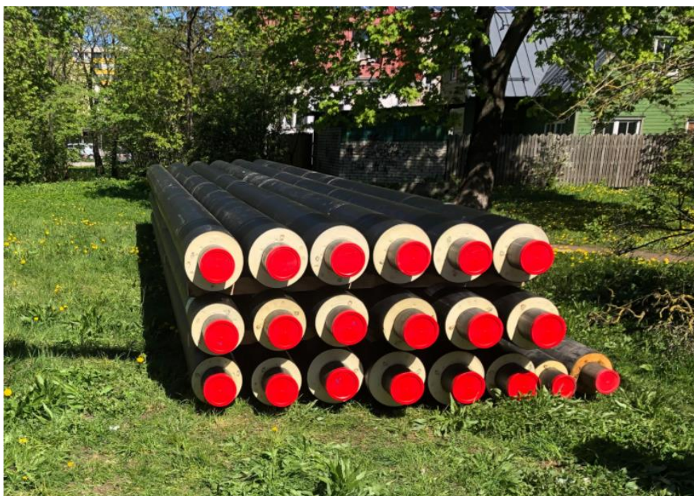
Joonis 2.4. Eelisoleeritud kaugküttetorud (allikas: HeatConsulti arhiiv)
