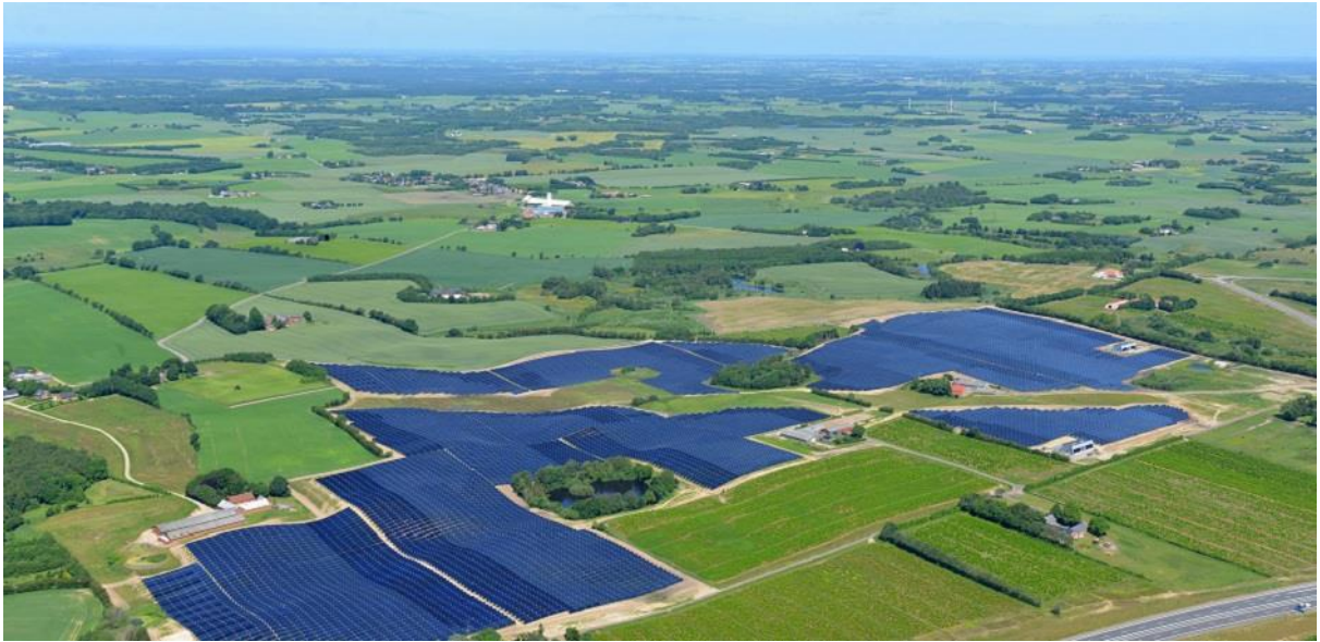
Joonis 4.12. Päiksekollektorite põld Silkeborgis Taanis (156 694 m 2 ) (allikas: http://arcon-sunmark.com )
